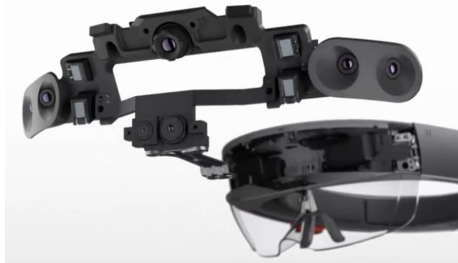
Şekil 1. Microsoft Hololensarttırılmış gerçeklik gözlük ve sensörleri (Microsoft 2018).
